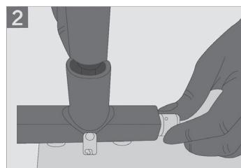
3. Работата може да се извършва по-ефективно и бързо чрез едновременно прилагане на сила с Т-образната дръжка и горната и долната дръжка.
